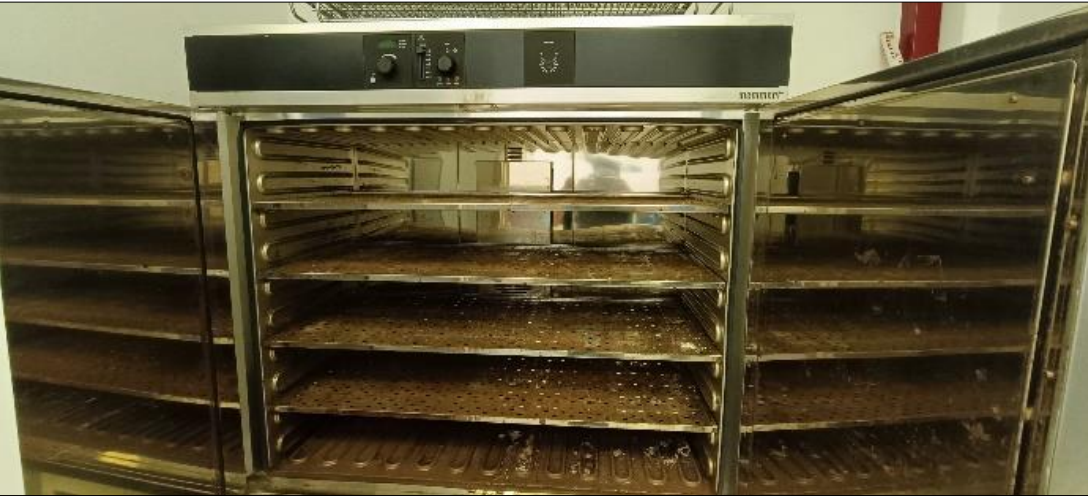
Estufa Memmert Be20 utilizada para el secado de las muestras
