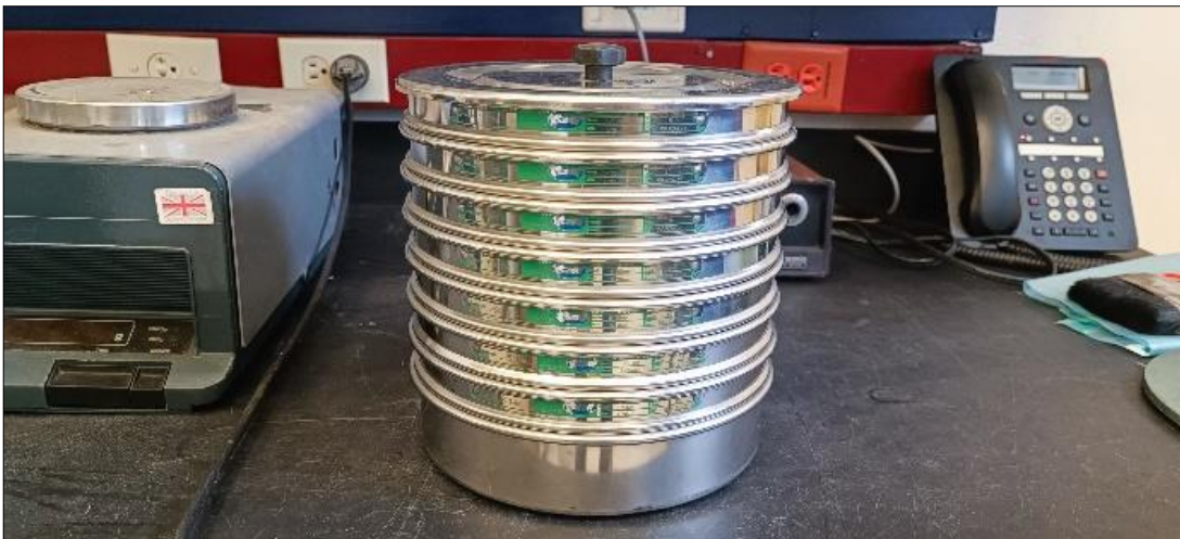
Juego de tamices utilizados para el tamizado de las muestras
