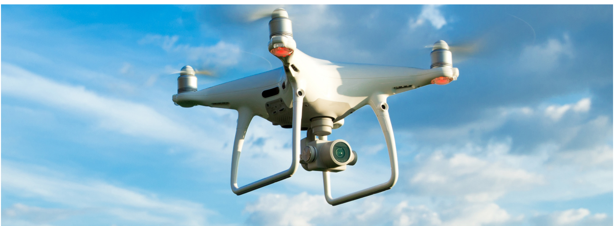
Figura 29. Levantamiento topográfico mediante fotogrametría con dron:
